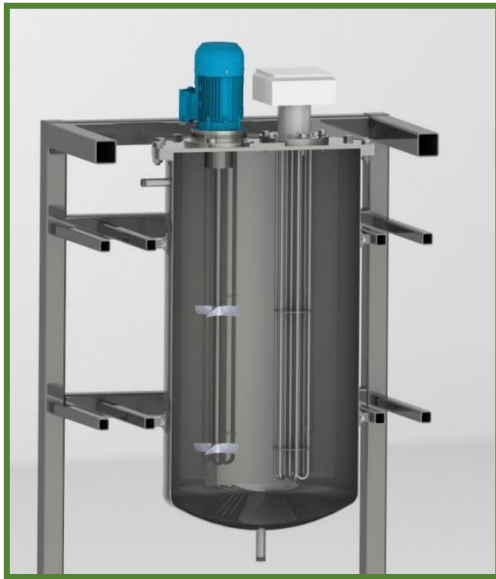
Figura 10. Tanque reactor, sistemas de agitación y calefacción.
