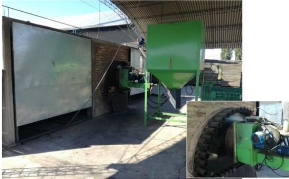
Fig. 7: Entrada de carros y salida de aire húmedo y quemador
