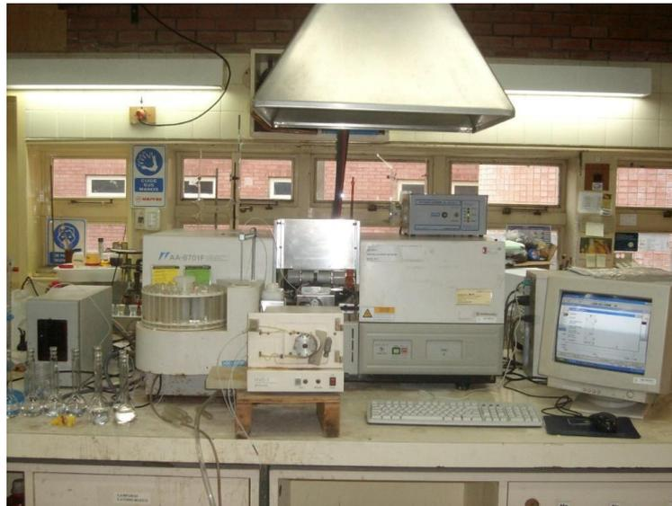
Figura 3: Primer Espectrofotómetro de Absorción Atómica de INTI Mendoza.
