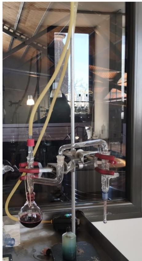
Figura 31: Equipo Rankine para determinación de Anhídrido sulfuroso Fuente: Foto propia
