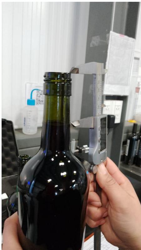
Figura 17: Medición de Espacio de Cabeza con calibre. Fuente: Foto Propia
