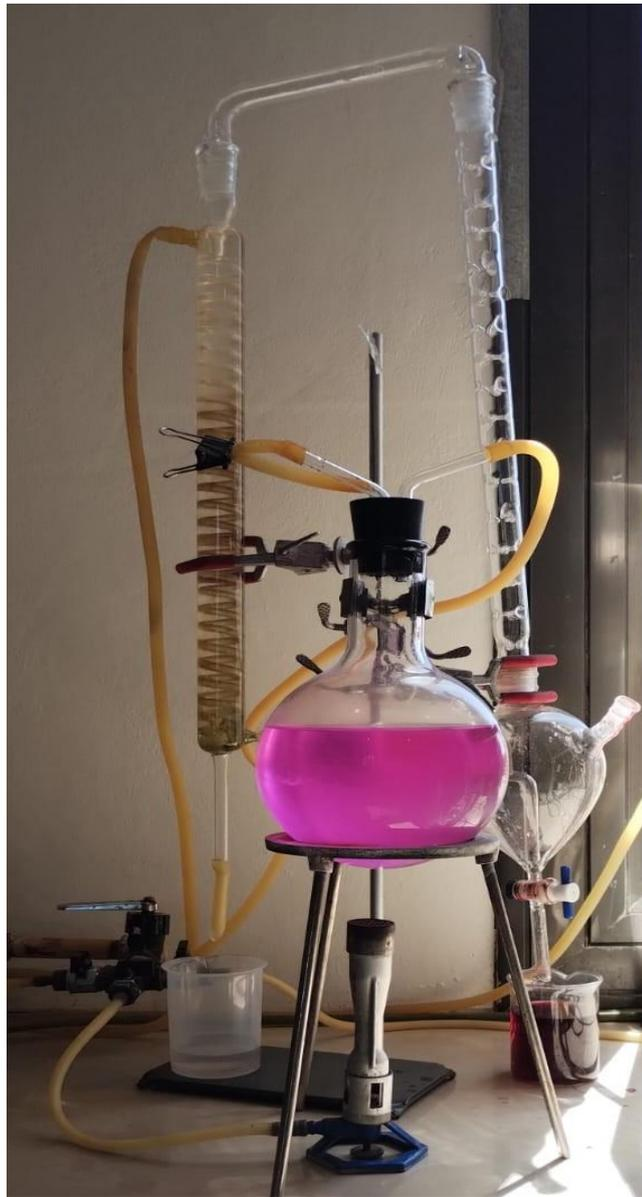
Figura 32: Aparato de destilación de Jaulmes. Fuente: Foto Propia
