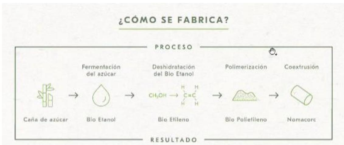
Figura 11: Proceso de obtención de tapones sintéticos 100% reciclables. Fuente: Nomacorc
