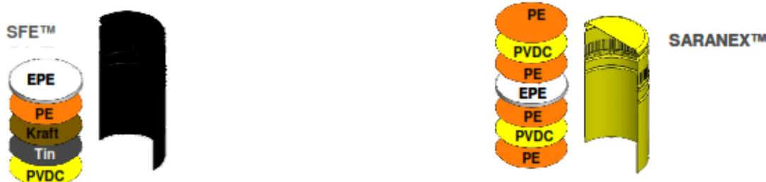
Figura 8: Composición de materiales de las distintas guarniciones de tapas rosca. Fuente: Ficha Técnica AMCOR
