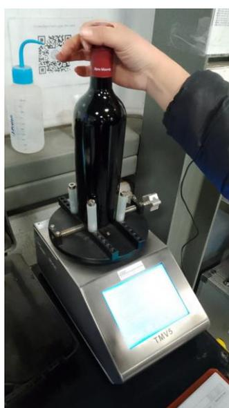
Figura 18: Medición de torque de arrastre. Fuente: Foto Propia
