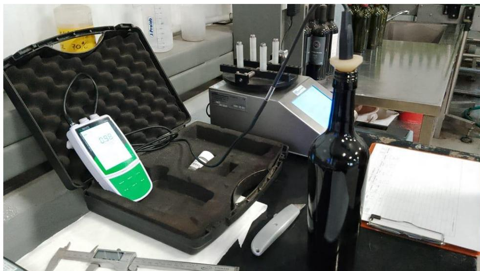
Figura 30: Medición de oxígeno disuelto Fuente: Foto propia
