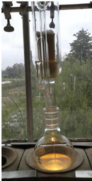
Imagen 37: Extractor en funcionamiento
