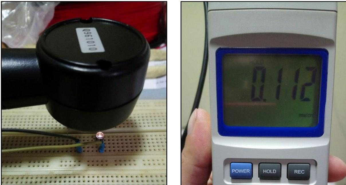
**Figura 11.** Medición de la luz emitida por el LED UV. Puede observarse el proceso de medición y la lectura.
