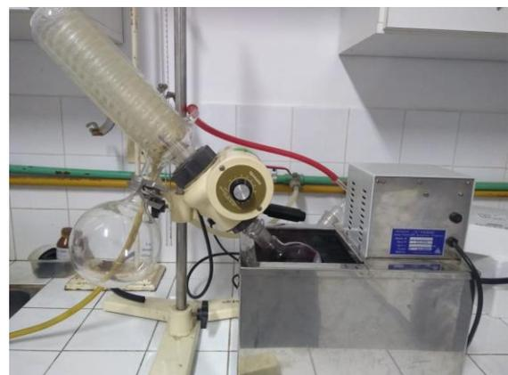
Figura 2. Evaporador rotatorio (rotavapor).
