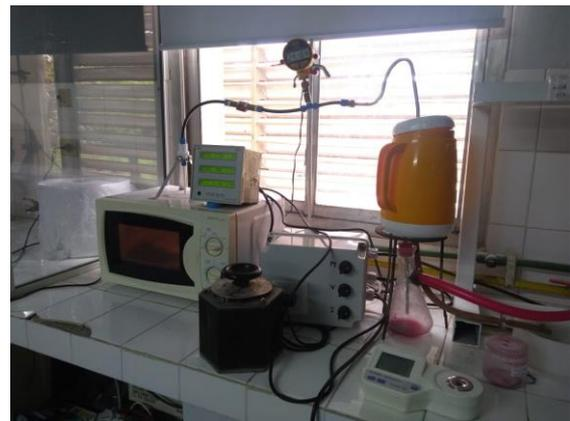
Figura 1. Microondas bajo vacío.
