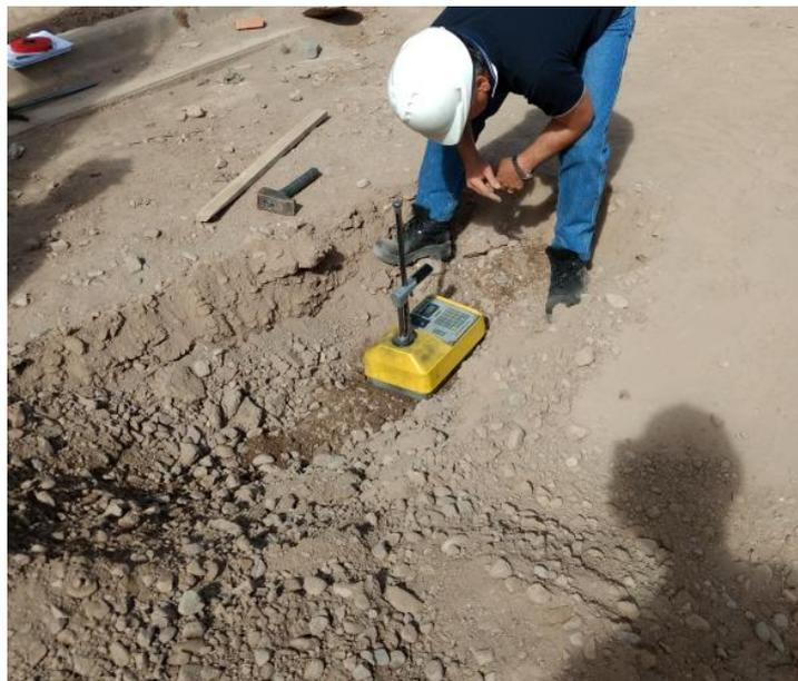
*Figura 3: Núcleo-densímetro*
