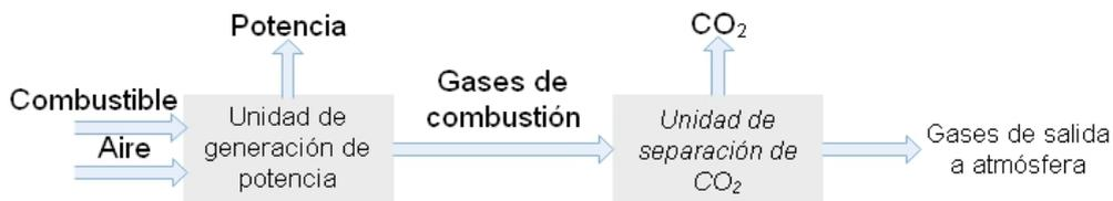
**Figura 1.7.** Esquema del proceso de post-combustión (adaptado de [15])
