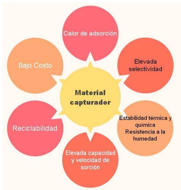
**Figura 1.10.** Propiedades deseadas en un material capturador de CO<sub>2</sub> (adaptado de [16])
