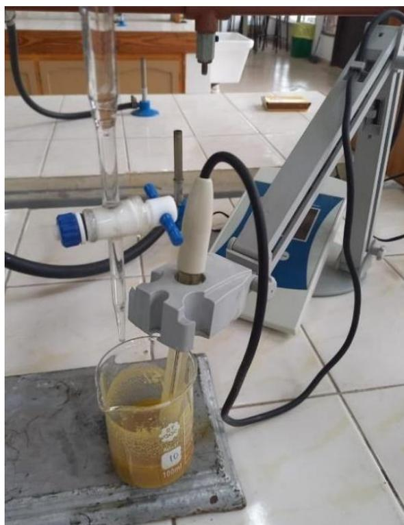
Figura 15: Determinación de la acidez por método potenciométrico.
