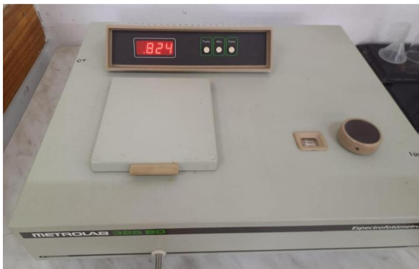
Figura 14: Lectura de la absorbancia en el espectrofotómetro (450 nm).
