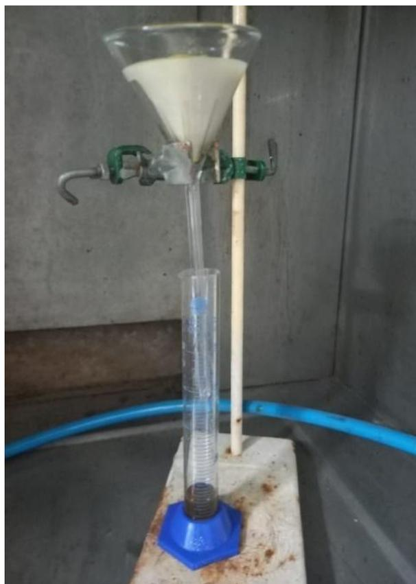
Figura 12: Filtrado para la determinación de Vitamina C. Fuente: Fotografía propia.
