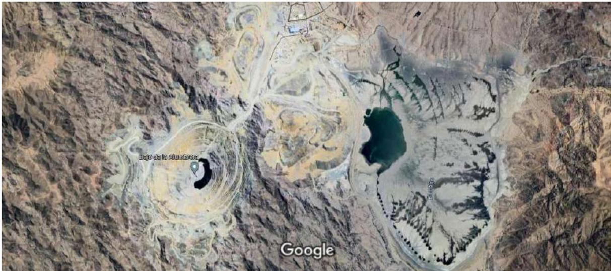
Imagen satelital actualizada de Mina La Alumbrera. A la izquierda se observa el hoyo de extracción o tajo abierto y a la derecha se encuentra el dique de cola.
