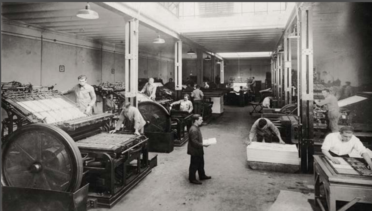
11. Antigua fotografía de Litografía Kraft con trabajadores en diversas tareas: impresión en grandes máquinas, armado de planchas, emparejado de papel y guillotinado.
