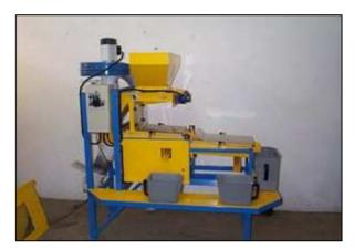
Luego de que la semilla es obtenida es importante que la misma se limpie. El objetivo es obtener una semilla limpia y de calidad. Para ello se utiliza la máquina que limpia y al mismo tiempo clasifica las semillas. Tiene una volta con alimentación variable que permite alimentar a diferentes tipos de semillas. Tiene cubiertas transparentes para monitorear el proceso.
