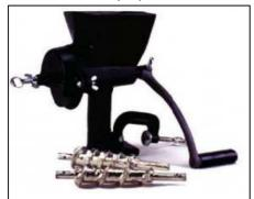
Es un equipo ajustable para graduar la molienda y la maceración y admite cambio de tornillos y dientes para maceración en seco o húmeda.
