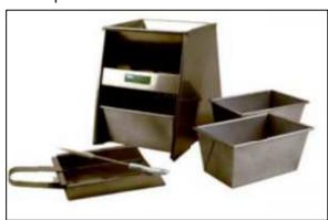
Es para separar muestras en dos partes iguales. La muestra se pone en la tolva la cual tiene dos compartimientos que dividen exactamente en dos porciones iguales. Costo \$8.474,80.
