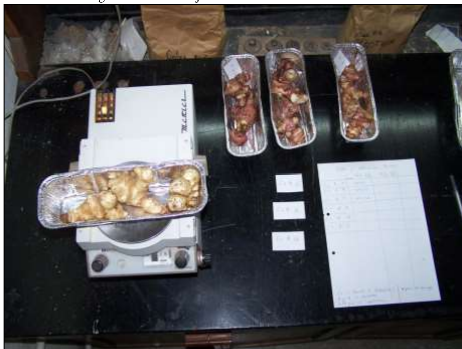
Fotografía N° 10. Pesaje de muestras antes de llevar a estufa
