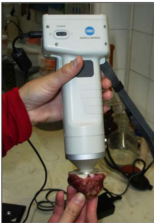
Fotografía N° 5. Medición de color de pulpa de topinambur
