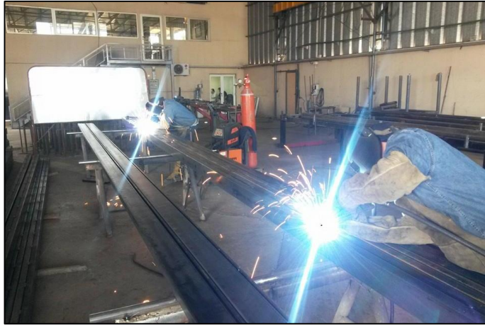
Fig. N° 17 – Fabricación de cajones de compresión y entrepiso.
